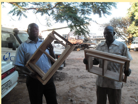
Moules pour fabrication des briques adobes (chimba briques) ou BTM
