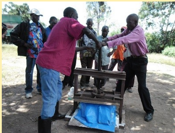
Les micro cossettes venant de la râpe trancheuse sont passées à la presse pour éliminer l'amidon et l'acide cyanhydrique
