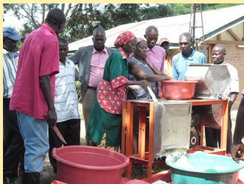
Production de micro cossettes avec la râpe trancheuse pour la production de farine de manioc.
